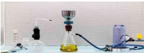
**Das „Herz“ des Zentrums ist die Prüfstand-Einrichtung**, die speziell zur Überprüfung der Betriebseigenschaften und der Leistung von Filterelementen und Kompletfiltern entwickelt wurde. Diese hochentwickelten Arbeitsstationen bieten eine sehr hohe Genauigkeit bei der Messung des Verschmutzungsgrades fester Partikel in einer Druckflüssigkeit.
